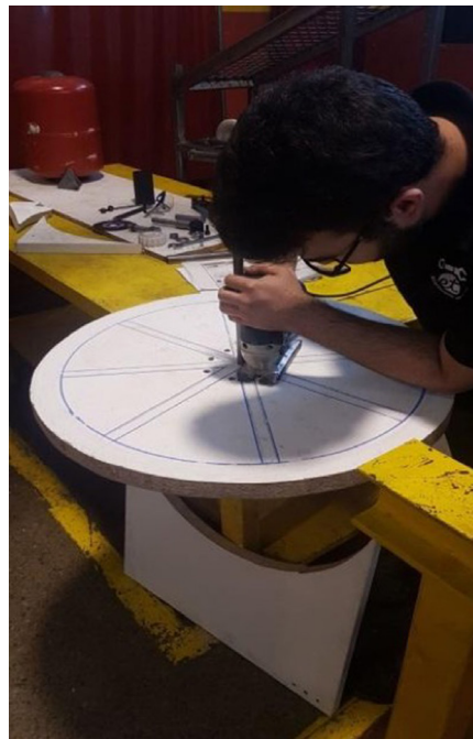
FIGURA 7. Mecanització del volant d'inèrcia amb caladora. FONT: Elaboració pròpia.
